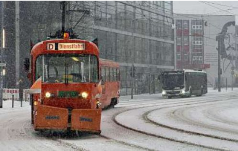
Für den Winterdienst haben die MVB zwei Tatra-Bahnen mit Räumschild im Einsatz. Auch die Fahrleitungen werden mit speziell ausgerüsteten Arbeitswagen eisfrei gehalten. ARCHIVFOTO: IVAR LÜTHE
